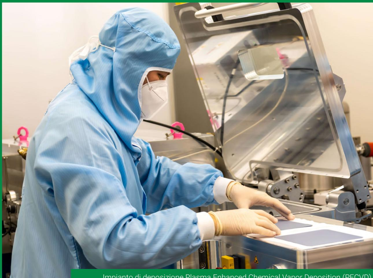
Impianto di deposizione Plasma Enhanced Chemical Vapor Deposition (PECVD) utilizzato per la fabbricazione di celle solari a eterogiunzione di silicio
