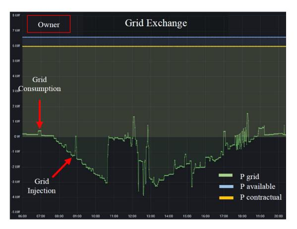
Monitoraggio dei singoli flussi di energia all'interno dell'abitazione: produzione fotovoltaica, ricarica dei veicoli elettrici e altri carichi
